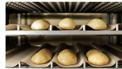
4. Rotosole устройство приподнимается - в результате чего хлеб находится в контакте с его горячей алюминиевой поверхностью.
